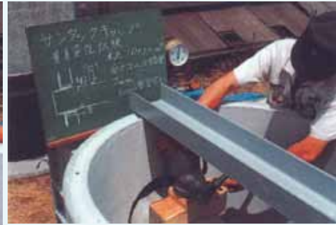
垂直変位試験 ヒューム管用呼び径250 管軸直角方向変位17mm 水圧1.0kgf/cm 2 -1時間異常なし
