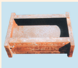
① 錆びた型枠
