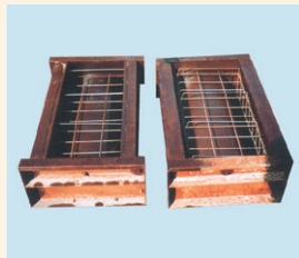
⑧ 型枠組み立て
