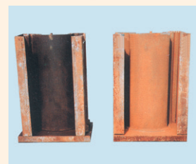
⑥ 黒サビ着化/ 左：セルバイン105を塗布した型枠（黒サビ） 右：ケレン処理だけの型枠（赤サビ）
